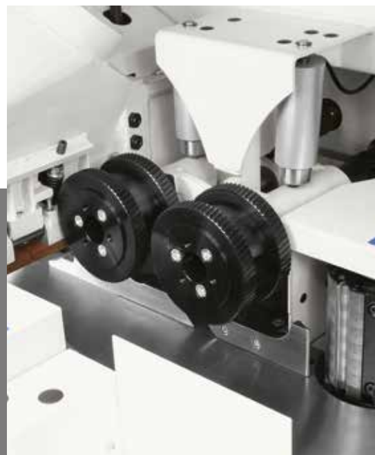
Kit de roues d'entraînement avec flasques supplémentaires devant l'arbre vertical gauche
