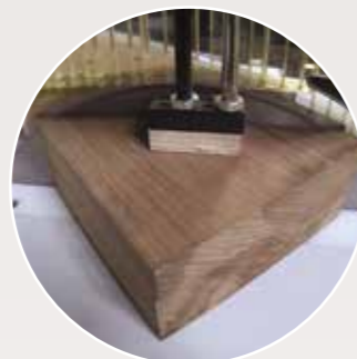
Sistema di bloccaggio pezzo con pressori verticali pneumatici Workpiece clamping system with pneumatic vertical clamps Système de verrouillage de pièces avec verins presseurs pneumatiques Sistema de bloqueo pieza con prensores verticales neumáticos
