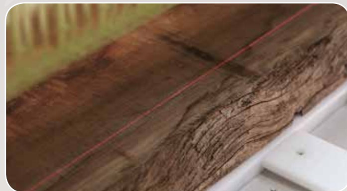
Laser per ottimizzazione del materiale Laser for material optimization Laser pour l'optimisation du matériau Láser para la optimización del material
