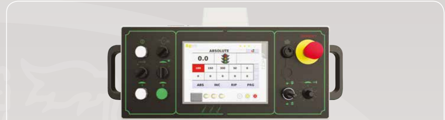
Il programmatore elettronico garantisce la gestione completamente automatica dei programmi di taglio. Consente di accedere a quattro distinti ambienti di lavorazione: assoluto, incrementale, ripetizione quota taglio, lista quote di taglio. Ottimizza i movimenti degli assi (spintore frontale e carro lama). Assicura la precisa e rapida salita della lama (3 posizioni) e permette di gestire la velocità di taglio in funzione dell'altezza del materiale e della larghezza dei refili. Contribuisce ad ottenere sempre la miglior qualità di taglio.
