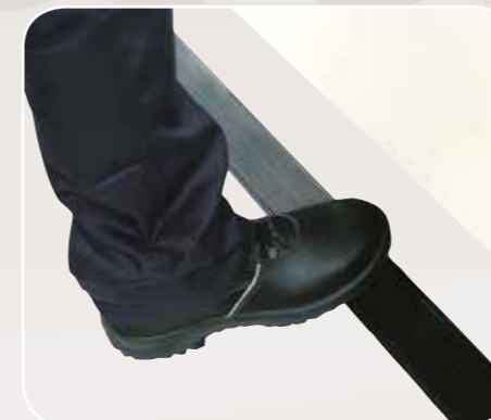
Avvio ciclo di taglio a pedale Starting of cutting cycle by pedal Démarrage du cycle de coupe par pédale Inicio del ciclo de corte por pedal
